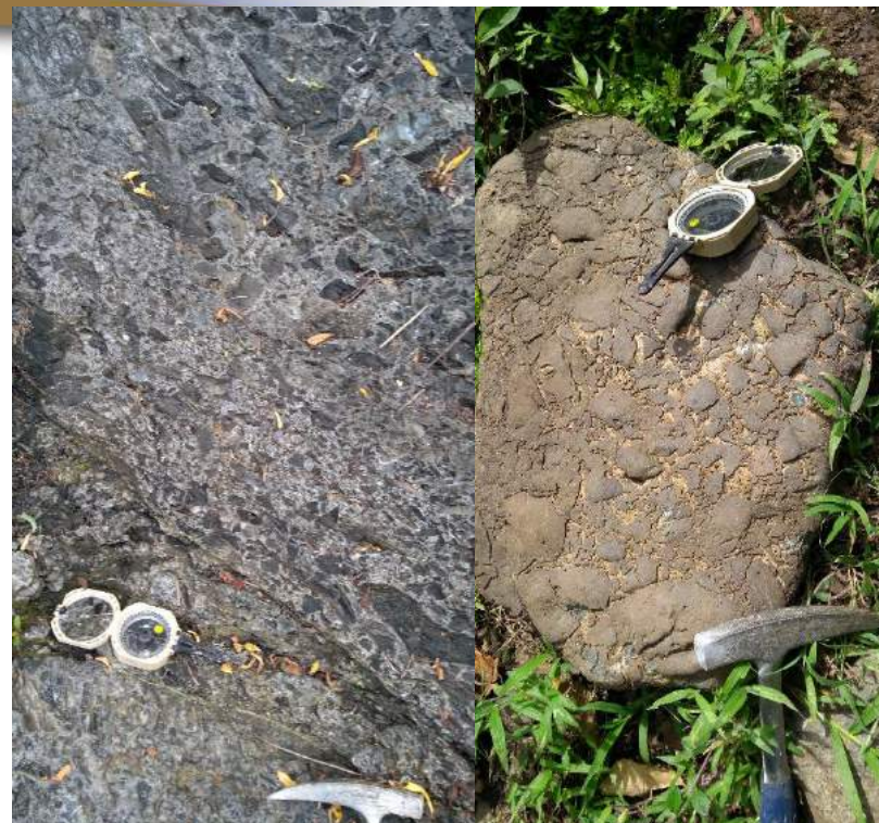
Breccia. Ca+-Sulfides+-Qz filling
